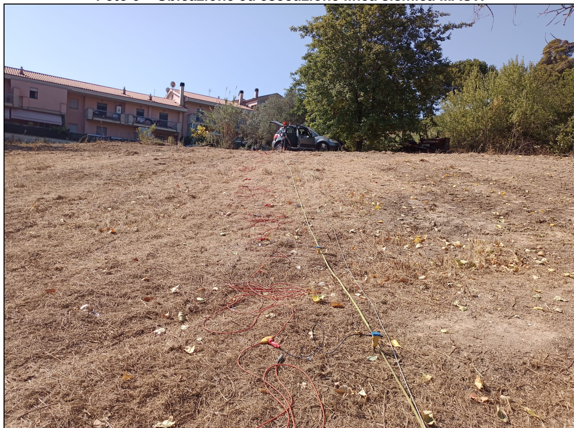
Foto 4 – Ubicazione ed esecuzione linea sismica a Rifrazione
