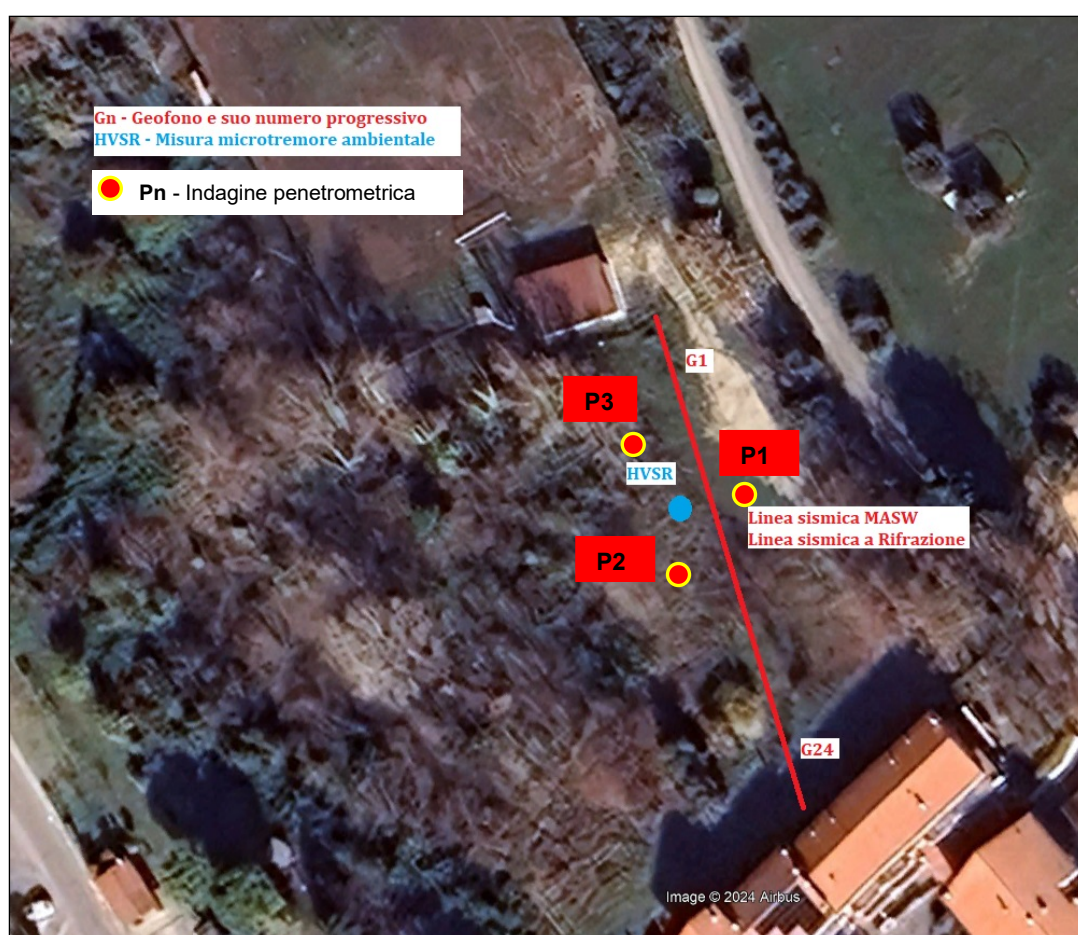
Fig. 5: ubicazioni indagini penetrometriche e sismiche
